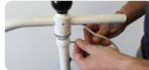
**4.** Coloque el contrapeso en la parte posterior del brazo horizontal girándolo en sentido horario. Nota: es importante fijar el contrapeso firmemente al brazo (hasta que no sea posible girar más en sentido horario).
