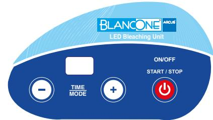
6. Wenn eine der Tasten TIMER + / TIMER - während den Operationen gedrückt wird, geht die Lampe in die Betriebsart Pause. Das blinkende Display mit der verbleibenden Zeit gibt an, dass das Gerät in Pause ist. Der Betrieb wird wieder aufgenommen, wenn Sie erneut die Taste TIMER + / TIMER - drücken.
